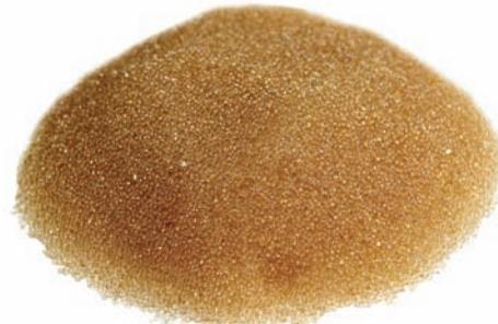
Рис. 4.4. Ионообменная смола.
