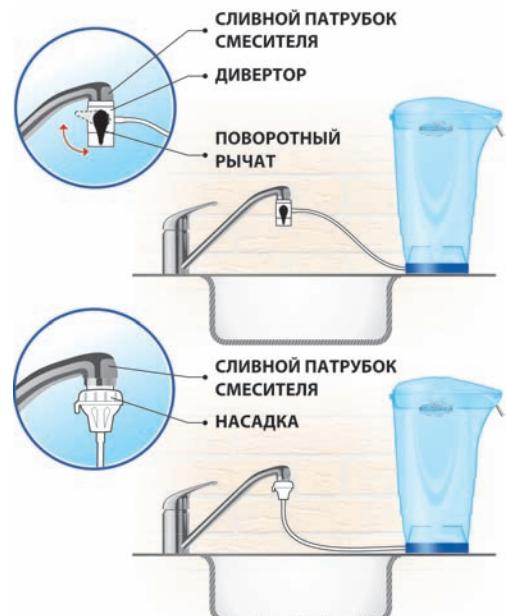
Рис. 4.17. Варианты подключения фильтра.
