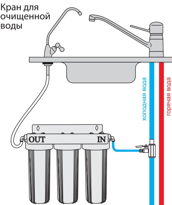
Рис. 4.21. Схема подключения фильтра под мойку «Водолей-БКП».
